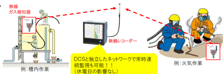
図5.3.2.2 無線ガス検知器で非正常作業時のリスク低減
