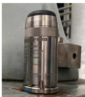
写真5.2.3.3 振動センサの外形(直径40mm x 高さ88mm)
