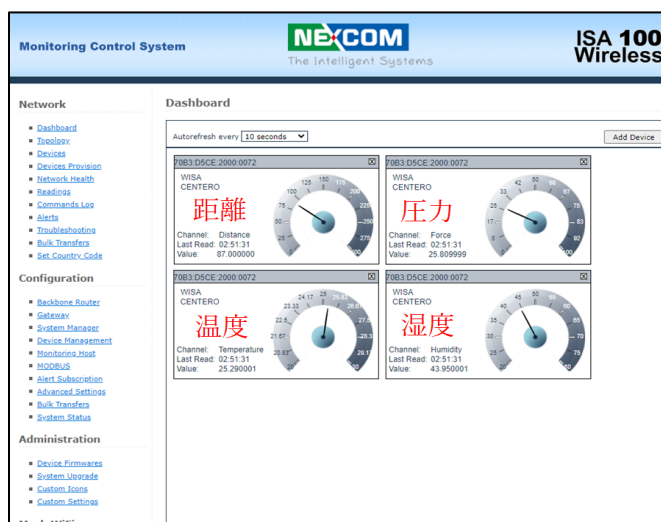
図6.2.3 ゲートウェイ Webアプリケーションによる監視画面の例
