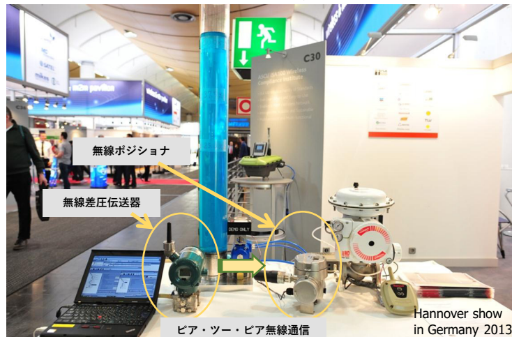
図C1-2 ISA100 Wirelessによるローカルループコントロールのデモの様子
