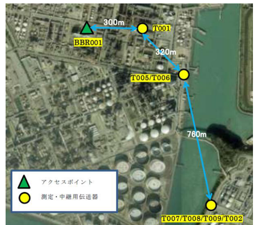
図 4.2.5.1 海越えテストの通信経路
