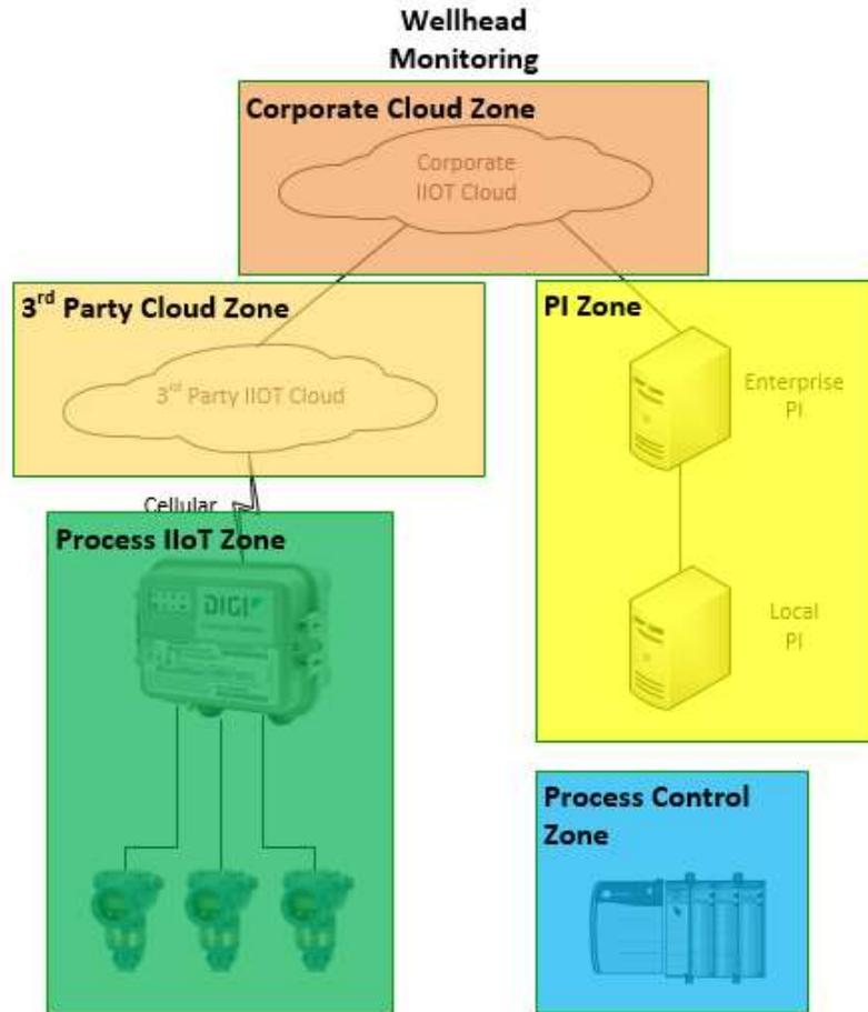
Figure 11: Architecture 1 Zone & Conduit Diagram
