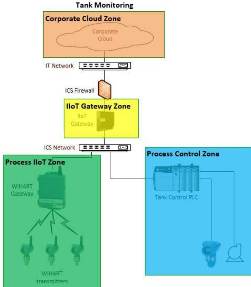
Figure 13: Architecture 3 Zone & Conduit Diagram
