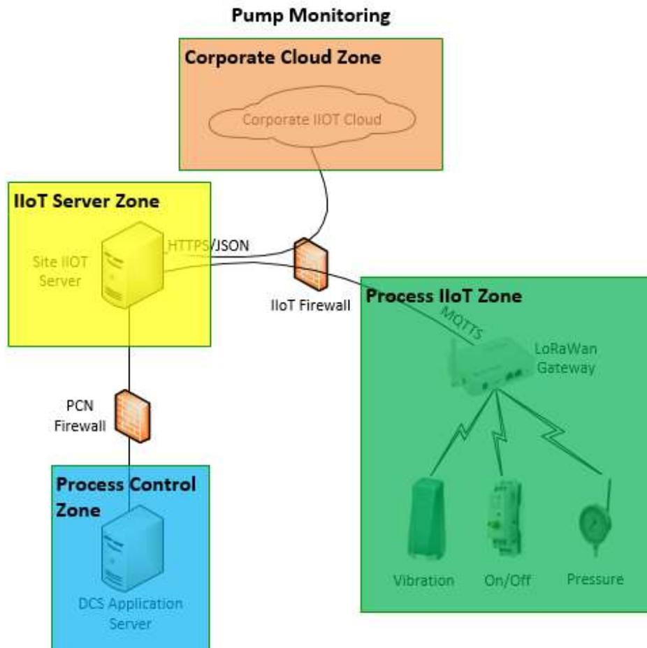
Figure 14: Architecture 4 Zone & Conduit Diagram
