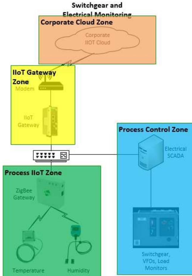
Figure 12: Architecture 2 Zone & Conduit Diagram
